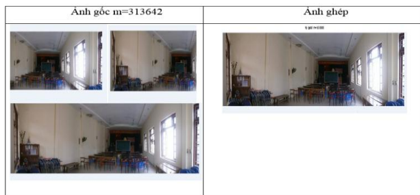
Hình 13. Lấy mẫu bằng phương pháp Nyquist. Ảnh ghép truyền với số lượng mẫu M=600000 , SSIM=0.9783
